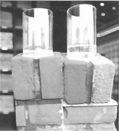
Proefopstelling vochttransport in de rollagen van de waterslagen (proef Rob Vermeulen).
